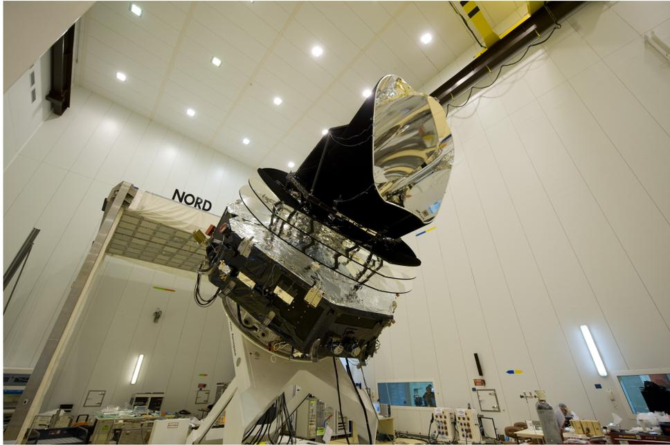
FIGURE 3.4 – Photo du télescope spatial *Planck* en laboratoire. Son miroir principal de 1.5 mètre de diamètre est visible en haut à droite. Crédit : ESA - S. Corvaja, 2009.
