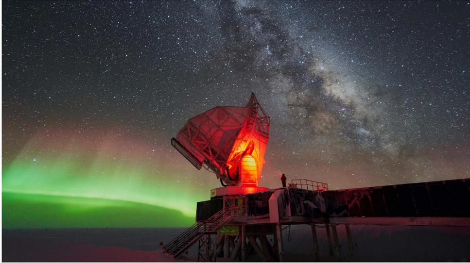
FIGURE 3.6 – Photo du South Pole Telescope avec son miroir principal de 10 mètres de diamètre, ici tourné vers la gauche. Crédit : NSF.
