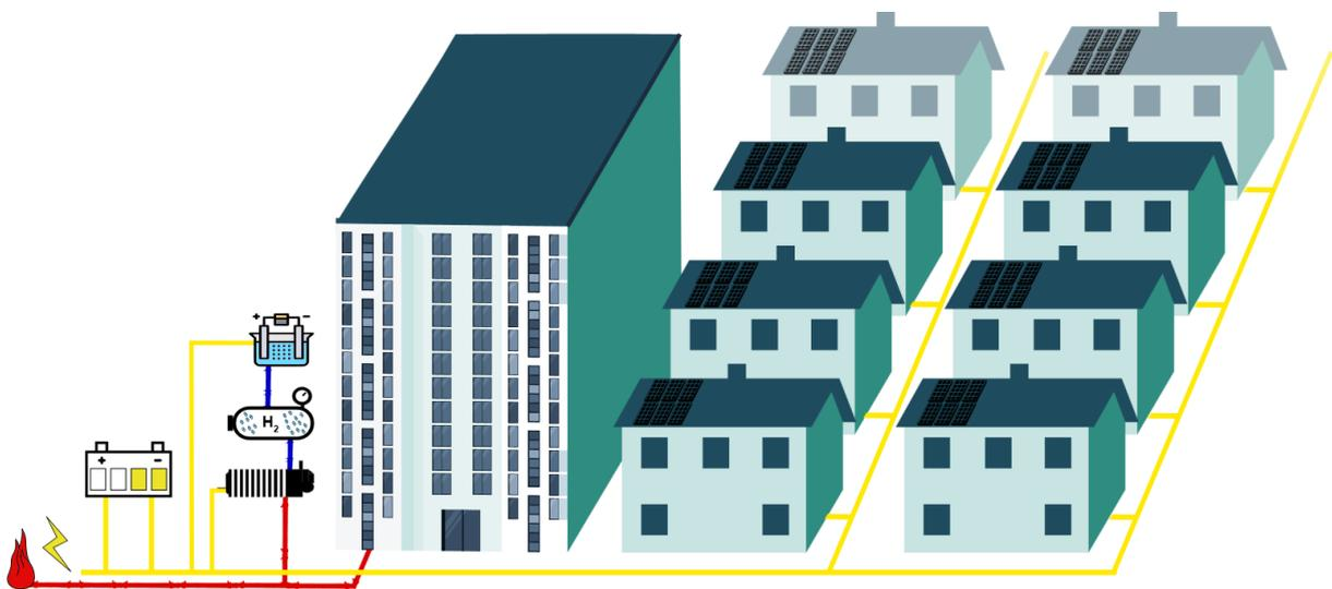
Figure III-9 : Architecture du système de stockage avec bâtiment central
