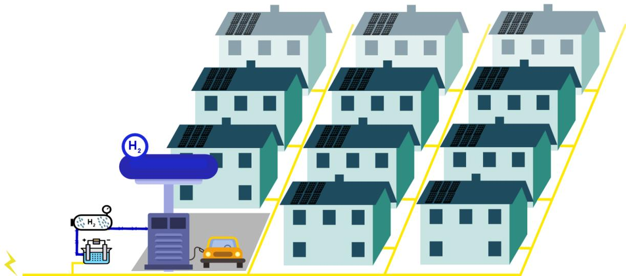
Figure III-10 : Architecture du système de production d'hydrogène pour le transport
