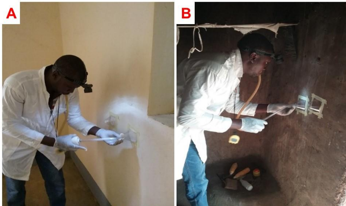
Figure 16 : Test en cônes OMS sur les murs en ciment (A) et en banco (B) (Source : Soma, 2018).
