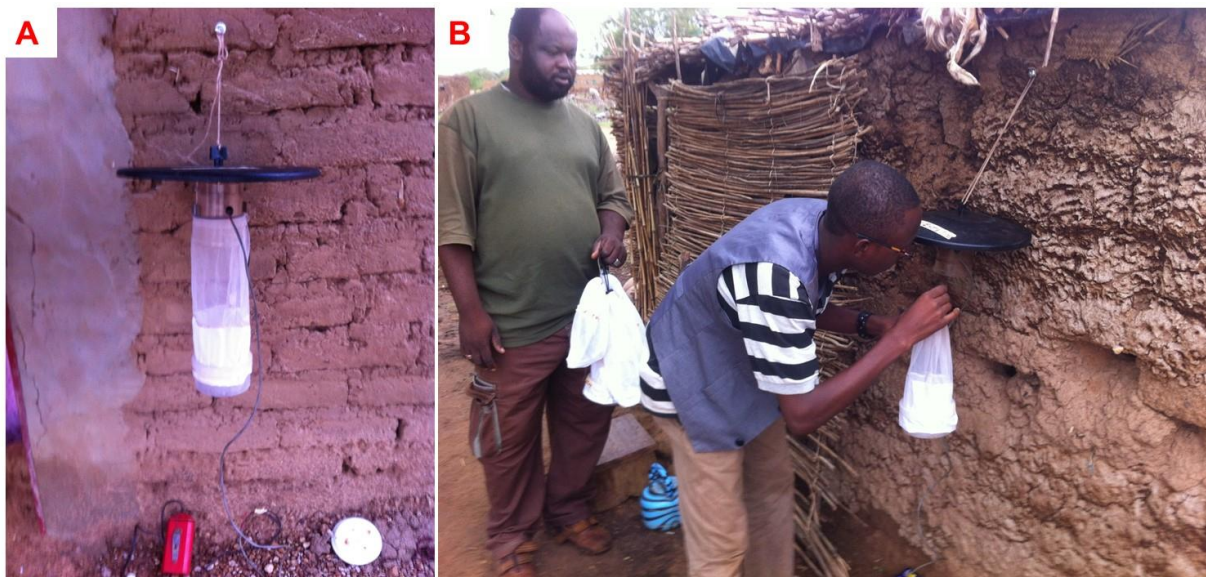
Figure 3 : Capture de moustiques par piège CDC. A : Présentation d'un piège lumineux ; B : Recupération de sac de Collecte de moustique (Source : Soma 2014).
