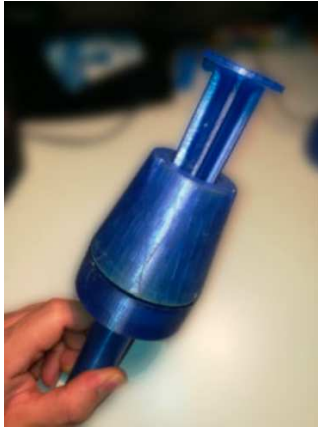
Figure 38 : Dispositif d'injection en « cône » réalisé par impression 3D
