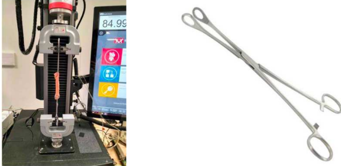
Figure 67 : Segment de nerf sciatique positionné dans l'appareil de mesure (image de gauche) et arrimé par deux pinces Foerster (image de droite)
