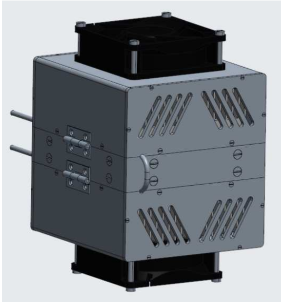
Figure 140 : CAO de l'échangeur final monté avec le bâti
