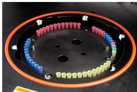
Image 4 : 48 positions disponibles permettant d'effectuer autant de synthèses simultanément.<sup>[185]</sup>
