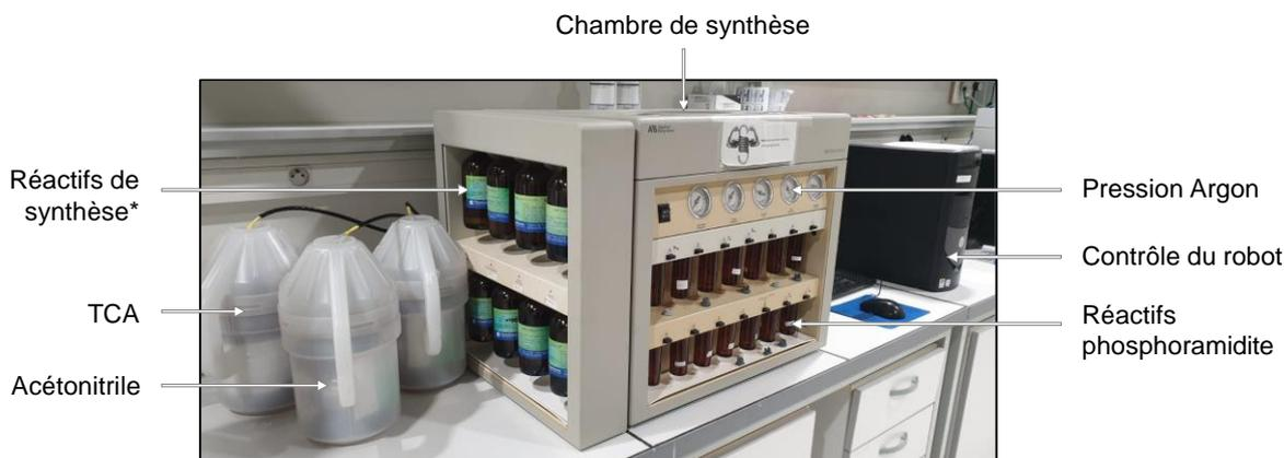
Figure II. 4 : Robot synthétiseur ABI3900 utilisé dans ces travaux.
