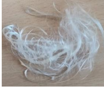
Figure 4.3 : Fibres de verre après dissolution du nylon dans l'acide sulfurique.
