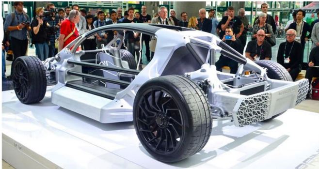
(e) Châssis de voiture imprimé partiellement en 3D (PSA) 11
