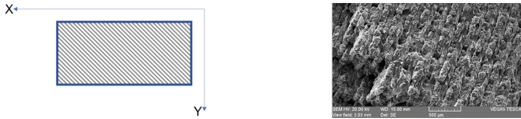
(c) Angle de dépose 2 ème couche à -45° (d) Structure interne d'une pièce en Onyx (coupe suivant XY).
