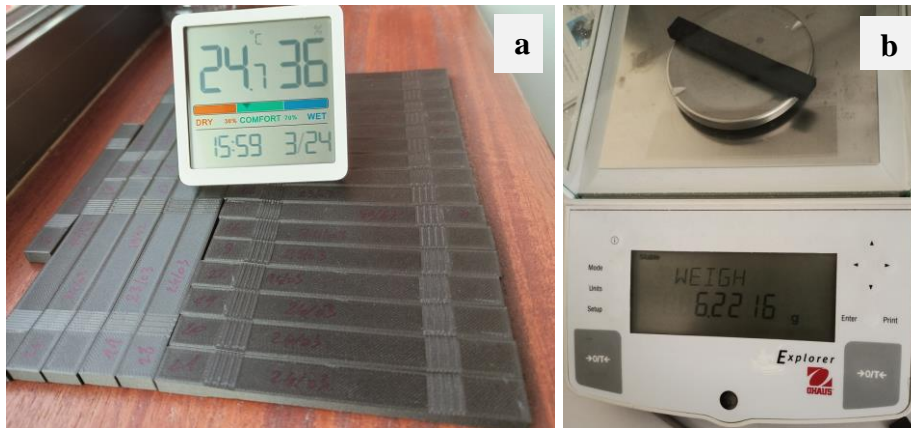
Figure 5.4 : Protocole de vieillissement a) éprouvettes en cours de vieillissement et b) pesée des éprouvettes avec la balance numérique Eplorer OHAUS (résolution 0,0001 gramme).
