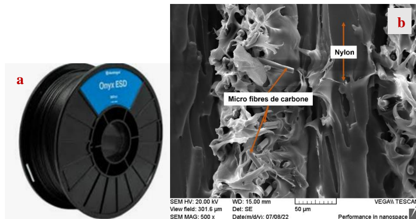
Figure 3.7 : a) Bobine d'Onyx b) image obtenue au microscope électronique à balayage (MEB).
