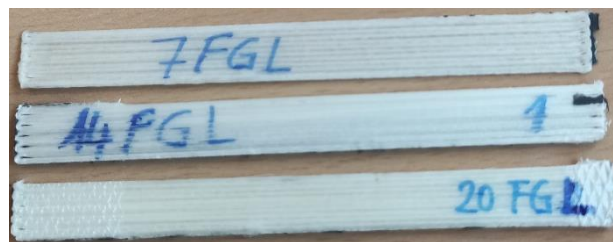
Figure 4.1 : Eprouvettes imprimées uniquement en filament de fibres de verre.
