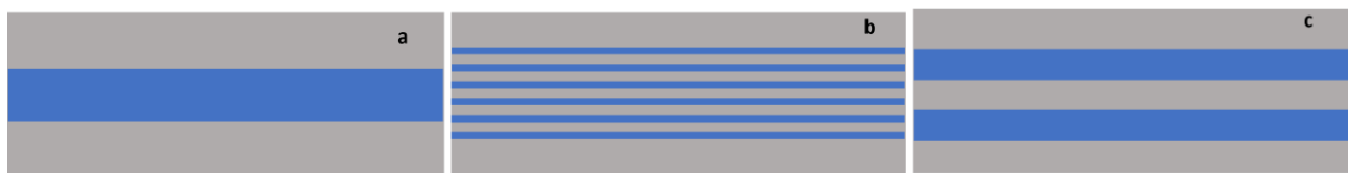
Figure 5.11 : Mode d'empilement des couches a) 1 bloc de 6 couches (6Lx1), b) 6 couches alternées par de l'Onyx (1Lx6) et c) 2 blocs de 3 couches (3Lx2).
