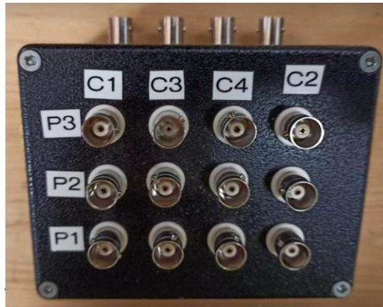
Figure 3-8 : Boîtier électronique de mesure des résistances des capteurs GMRs. La sonde est connectée au boîtier par un connecteur Sub-D à 25 voies, les résistances des capteurs peuvent ainsi être mesurées en sortie des BNC. Ce boîtier permet également de mesurer la  $R(H)$  et le bruit (cf Chapitre 2.III.a. et b.).
