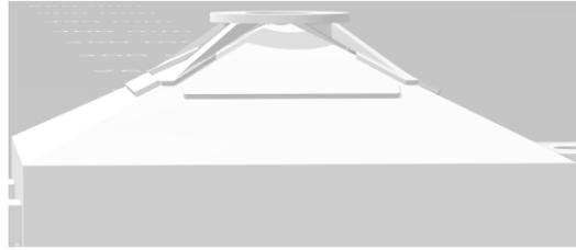
Figure 3-11 : Vue 3D du support pyramidal avec un anneau de protection au-dessus de la pointe.
