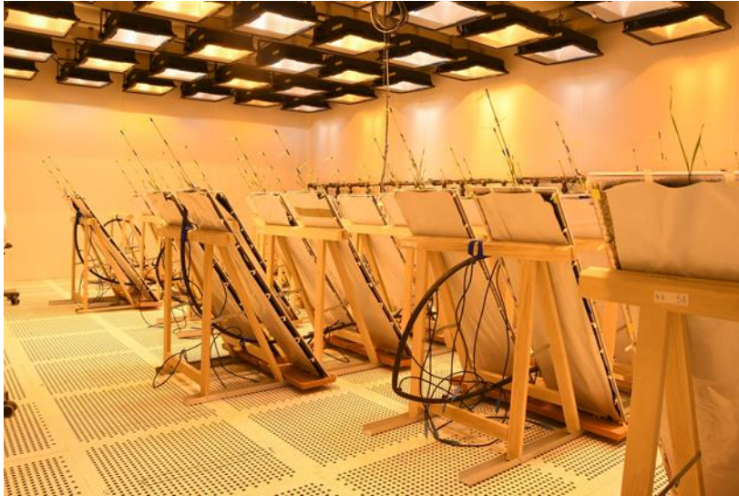
Figure 3.3 : Photographie des rhizoboxes et des dispositifs de maintien dans le phytotron de l'UMR IGEPP.
