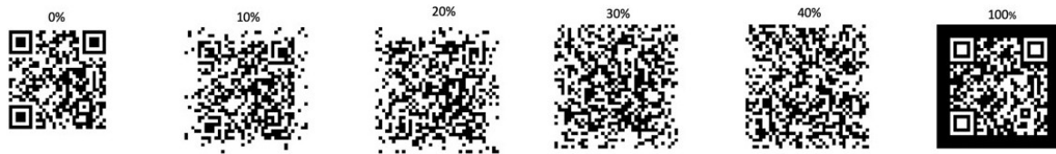
FIGURE 2.6 – QR codes dont un pourcentage de la surface totale est bruitée en inversant la valeur des pixels (un pixel noir devient blanc et inversement).
