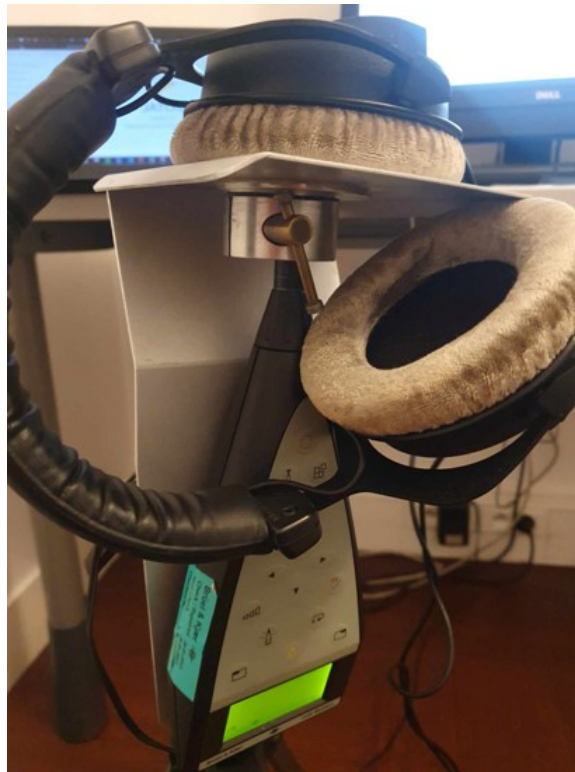
Figure 4.8. Calibration du niveau de restitution du casque au sonomètre.
