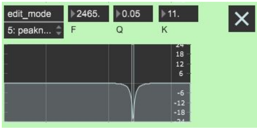
Figure 3.12. Filtre coupe-bande appliqué en dernier lors de la création du masque attentionnel A1. On peut lire sur la capture une valeur de facteur de qualité Q = 0.05 , un gain K = -11dB et une fréquence de coupeure F = 2465Hz .
