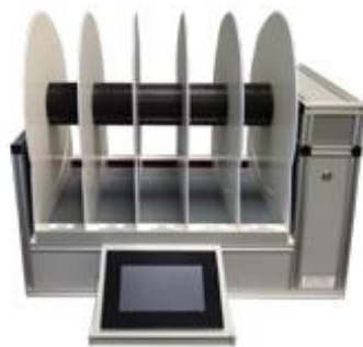
Figure 21. Rotarod utilisé pour évaluer la vitesse de marche des souris ou des rats.
