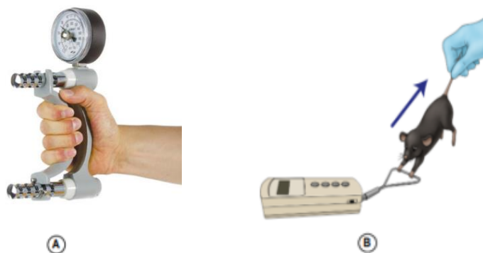
Figure 20. Dynamomètre Jamar, validé pour mesurer la force de préhension chez l'Homme (A). Griptest pour mesurer la force de préhension chez les rongeurs (B).
