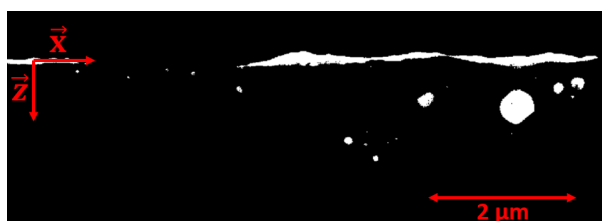
FIGURE A.5 – Exemple de résultat après le traitement d'image des images BSE. Sur les images, les oxydes apparaissent en blanc et le reste (matrice d'acier et le vide) en noir. Dans Matlab, l'image binaire (une matrice) est composée de 1, les oxydes, et de 0, le reste.
