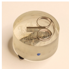
(a) Grande section polie dans la résine époxy à froid
