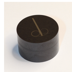
(b) Grande section polie dans la résine conductrice
