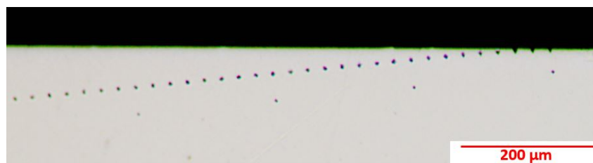
FIGURE 4.7 – Image optique de la position des empreintes pour la mesure de dureté sur l'échantillon recuit T_{800}t_{120}
