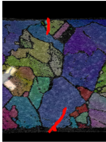
FIGURE 4.33 – Superposition de la localisation de fissure avec la cartographie EBSD de l'éprouvette de traction
