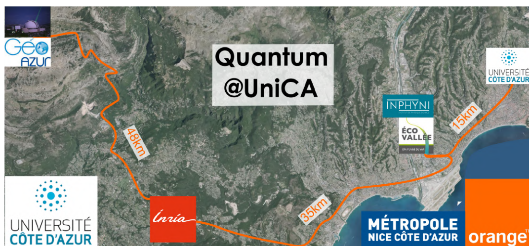
Figure 2.16 – Q@UniCA : Il s’agit d’un réseau de fibres optiques dédiées aux expériences de communication quantique. Ces fibres ne transportent aucun autre type de signal optique que des états quantiques. Il est constitué d’une centaine de brins de fibre optique standard aboutés les uns aux autres pour obtenir un unique lien de 100 km présentant des pertes totales de 35 dB, c’est-à-dire à l’état de l’art mondial. Trois des quatre nœuds sont équipés de détecteurs de photons, d’un système de datation temporelle et des moyens de communication très haut débit. Les sites de l’éco-vallée et de l’INRIA sont de simples salles serveur, tandis que les sites de Nice-centre et de GéoAzur sont de véritables laboratoires. En outre, le nœud de Caussols est connecté au télescope d’observation astronomique pour préparer les futurs liens spatiaux par satellite.
