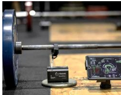
Figure 18 : Placement d'un encodeur linéaire (Gymaware) destiné à mesurer la vitesse de la barre sur différents mouvements.
