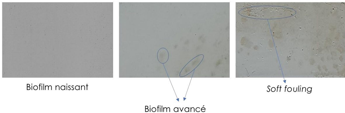
Figure 30 : Photographies de revêtements présentant plusieurs catégories de biofilms.
