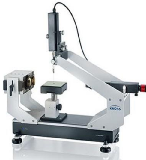
Figure 15 : Photographie de l'appareil permettant les mesures d'angle de contact (DSA 30, Krüss).
