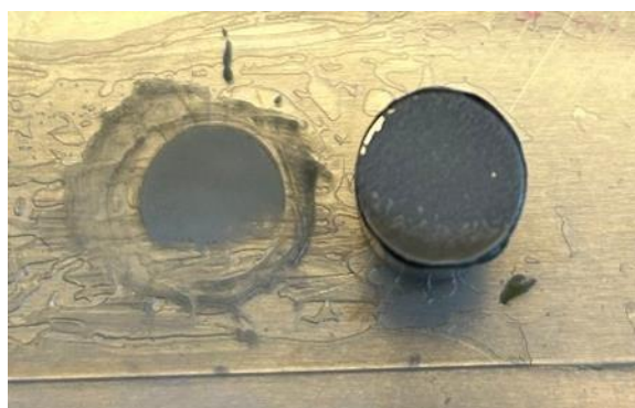
Figure 2 : Photographie illustrant la rupture cohésive entre la colle epoxy et le revêtement à base de PEGMEM, après rupture du plot.
