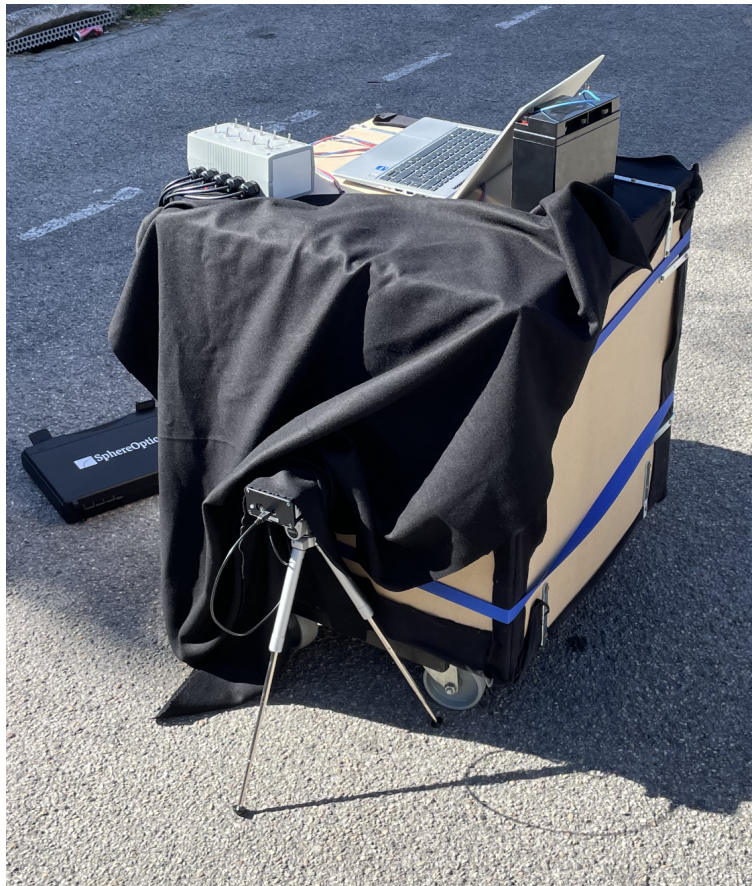
FIGURE 4.4 – Mesure de la luminance spectrique de la source halogène en réflexion sur un échantillon de Spectralon en extérieur.
