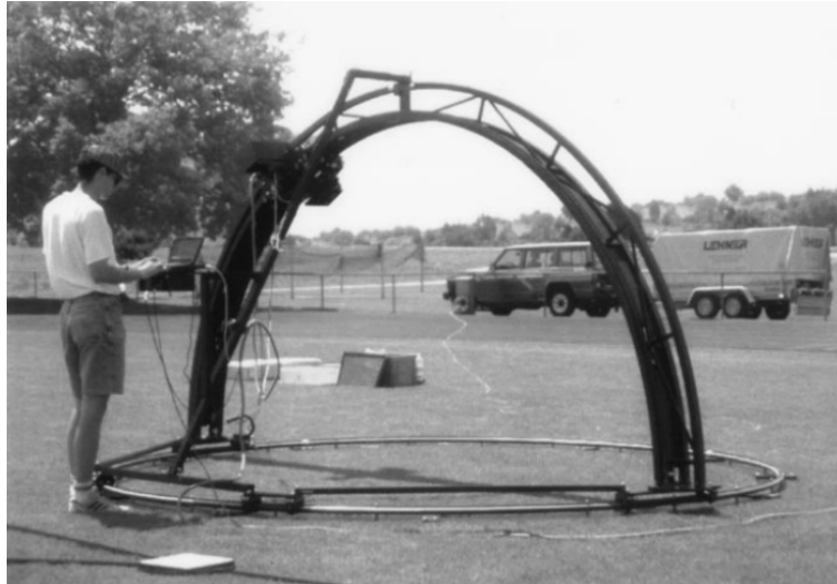
FIGURE 5.4 – Dispositif de type goniophotomètre en extérieur développé par R. Sandmeier et al. (image issue de [Sandmeier et Itten, 1999]).
