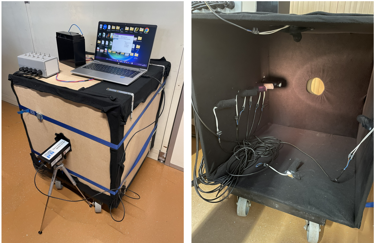
FIGURE 4.7 – Dispositif de mesure de composantes spectrales de matériaux pendant une mesure du matériau d'un mur, puis ouvert avec la source n°3 allumée.
