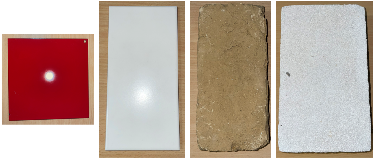
FIGURE 4.11 – Échantillons de matériaux, de gauche à droite : peinture rouge, carrelage blanc, brique terre cuite, brique en ciment blanc.
