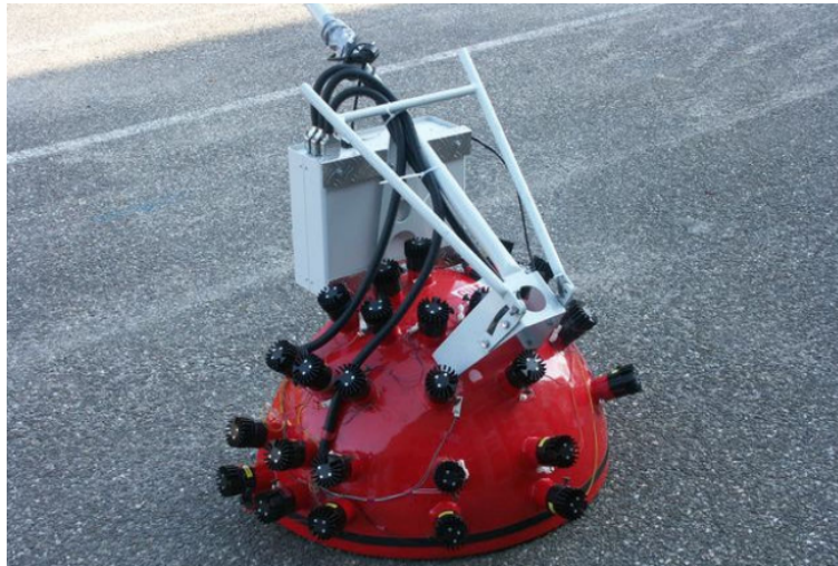
FIGURE 5.3 – Dispositif COLUROUTE développé par Muzet et al. (image issue de [V. Muzet, 2008]).
