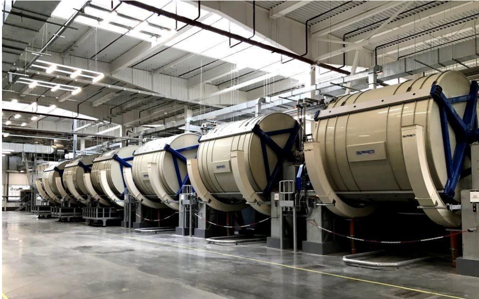
Figure 3 : Installation de foulons industriels en polypropylène. ( http://www.italprogetti.it )
