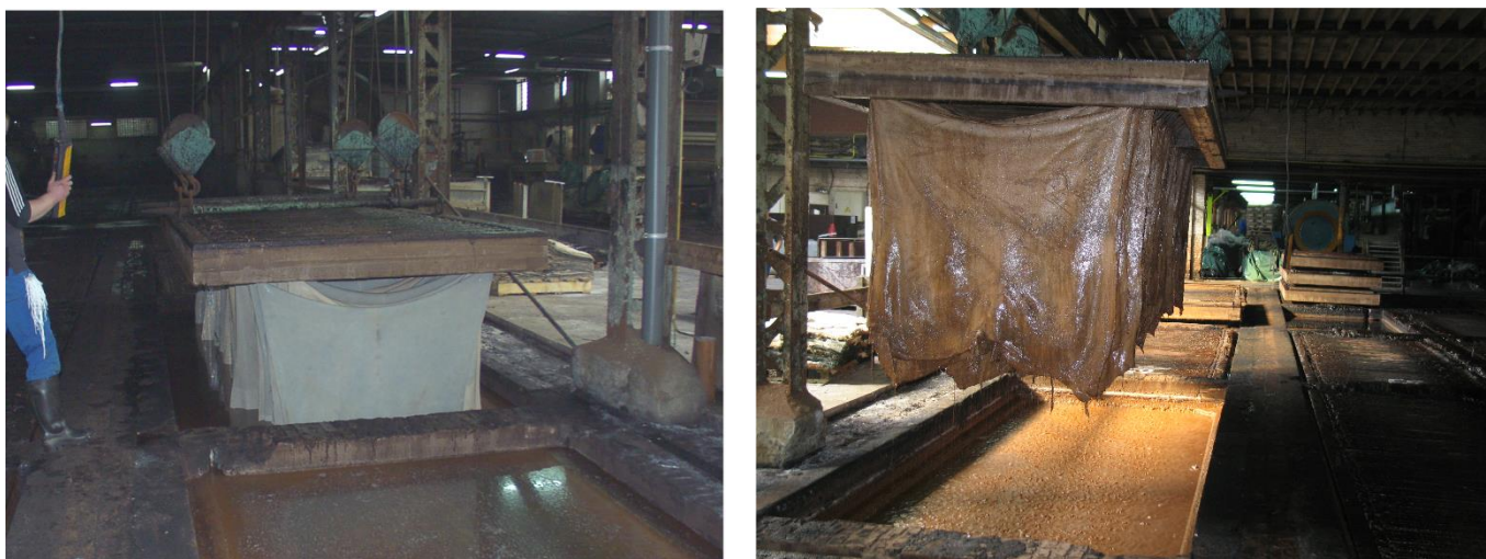
Figure 9 : Tannerie Masure (années 2000) : entrée des peaux en tripe (gauche) en cuve 1 et sortie des cuirs en dernière cuve (droite)
