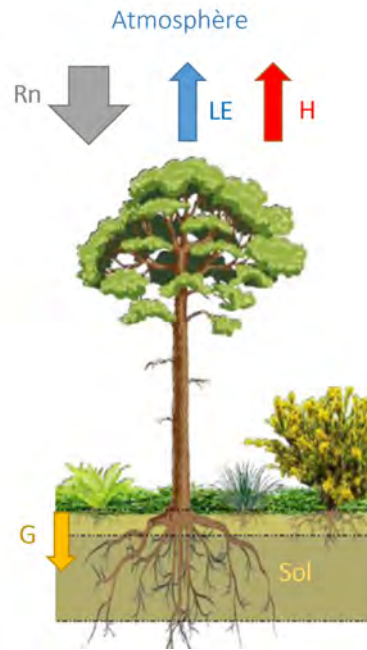
FIGURE 2.8 – Flux d'énergie disponibles ( Rn - G ) et dissipés ( H + LE ) en surface
