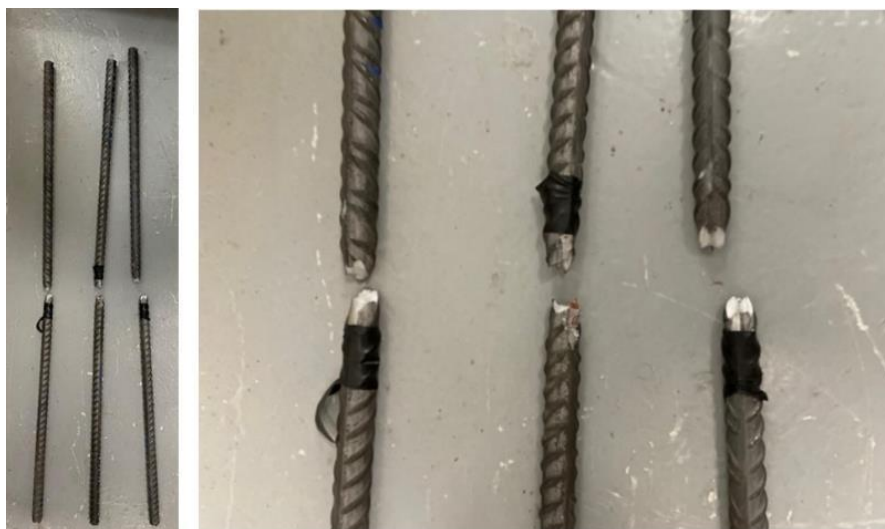
Figure 2. 5 : Photos des barres continues à la rupture
