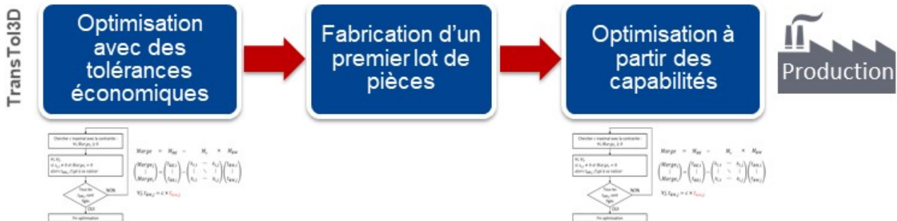
FIGURE 2.11 – Méthodologie d'optimisation des tolérances à partir des données de production, appliquée au tolérancement de fabrication
