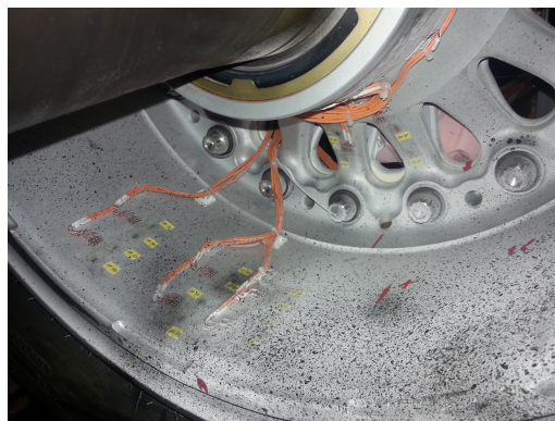
FIGURE 2.7 – Illustration des jauges positionnées sur la roue
