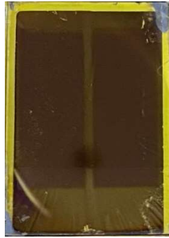
Figure 136 - Photo d'un échantillon V/ITO/2PACz/PK WBG/C 60 /SnO x /ITO rec /PEDOT:PSS. La zone marron définit le masque de C 60 , les rectangles plus foncés à l'intérieur de cette zone définissent l'ITO rec . Le SnO x est déposé sur toute la surface. Les zones jaunes correspondent à la PK décomposée en Pbl 2 .
