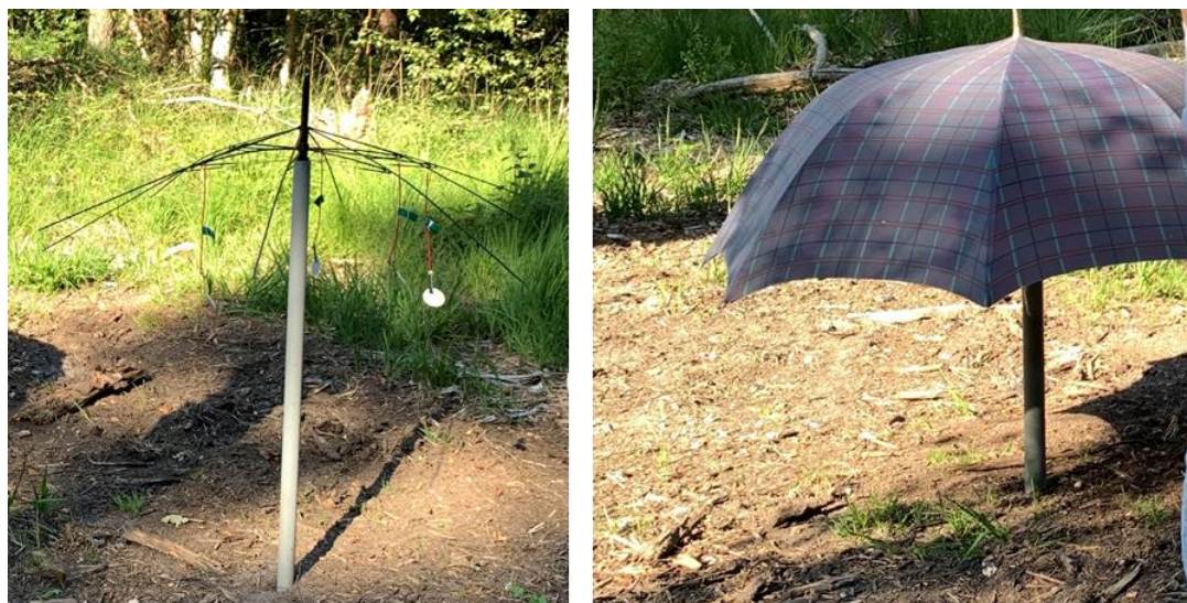
Figure A3-1 : Montage expérimental des supports de type parapluie pour l'exposition de poinçons dans le cadre d'expériences de réactivité in situ de marqueurs d'AOS au cœur de la forêt de Rambouillet dans le cadre de la campagne ACROSS en juillet 2022. Les échantillons ont été accrochés sur des parapluies avec une exposition à la lumière directe (gauche, sans toile) ou indirecte (droite, avec toile).
