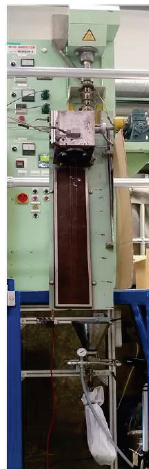
Figure 4 : Schéma (gauche) et photographie (droite) du système de filage à haute vitesse à étirage aérodynamique.
