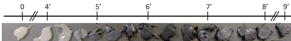
Figure 3 : Estimation du temps de séjour (échantillonnage toutes les 20 secondes) d'un grade de PET vierge mélangé à du noir de carbone à t=0 .
