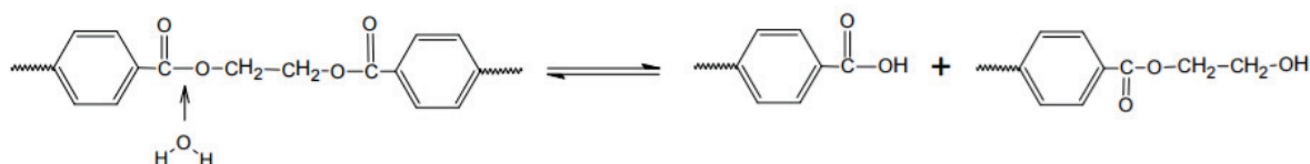
Figure 4 : Mécanisme de dégradation hydrolytique du PET, tiré de Nait-Ali et al. [6].
