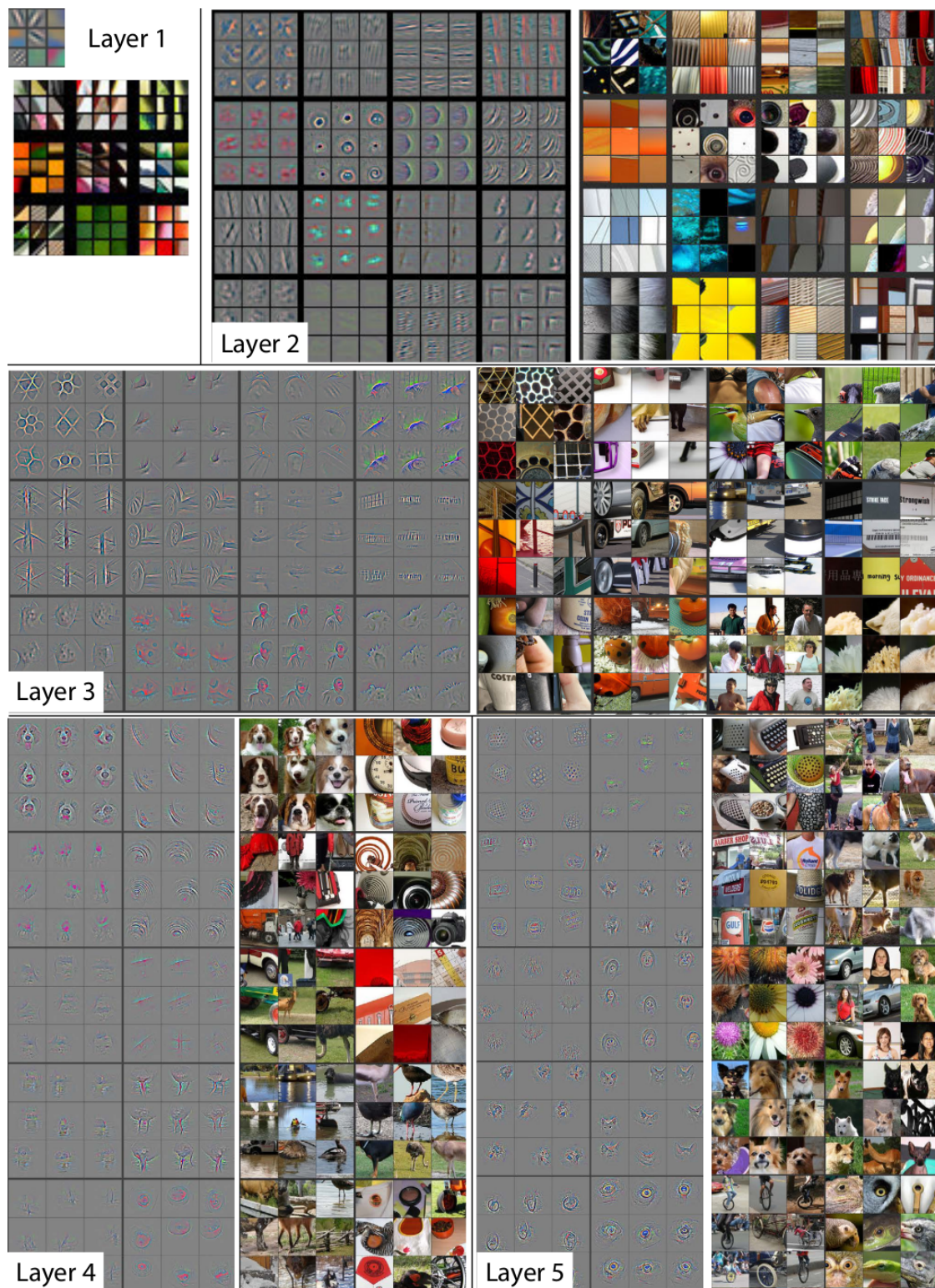
FIGURE 2.4 – Visualisation des caractéristiques apprises par un modèle entraîné sur ImageNet par la méthode des réseaux déconvolutifs. [125]
