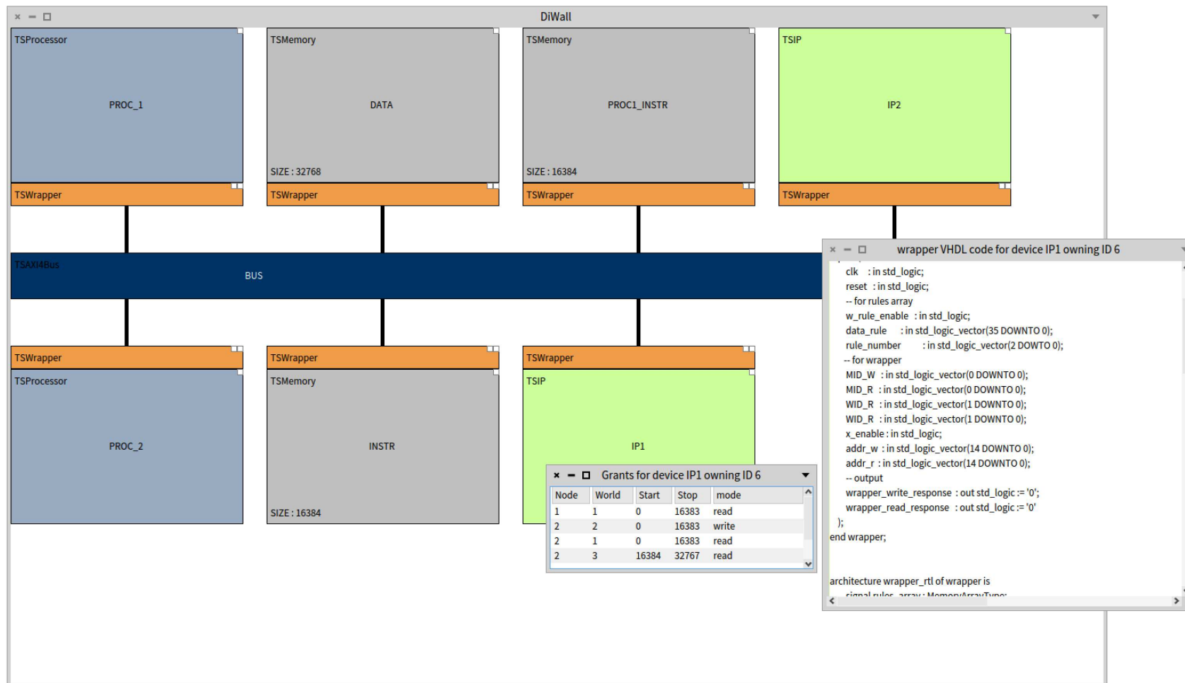
FIGURE 5.10 – Interface graphique utilisateur de l’outil DiWall avec un exemple d’architecture de SoC hétérogène.
