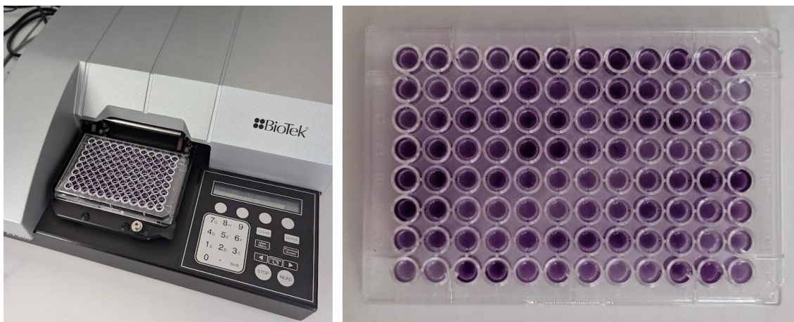
FIGURE 27 : MISE EN PLACE DU PROTOCOLE DE QUANTIFICATION DES PROTÉINES TOTALES PAR DÉTECTION COLORIMÉTRIQUE AU LABORATOIRE MICORALIS
