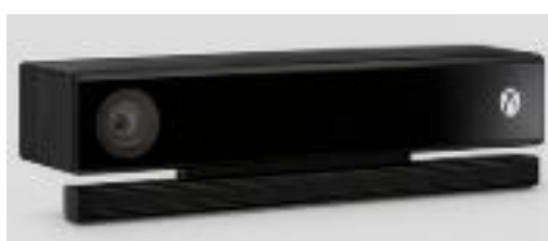
Figure 8. Exemple de caméra de suivi de mouvement de type Kinect utilisée pour l'analyse de la posture et de la mobilité [69]
