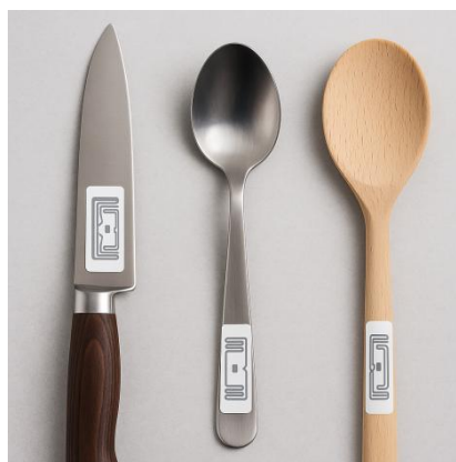
Figure 7. Exemple de capteurs RFID passifs appliqués à des ustensiles de cuisine pour le suivi des interactions alimentaires [141].
