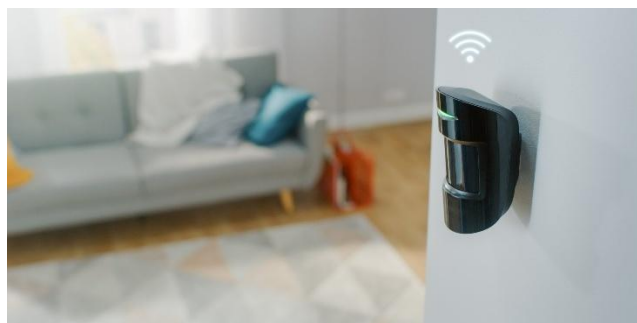
Figure 6. Capteur ambiant connecté (IoT) de type détecteur infrarouge passif (PIR) pour le suivi de la présence et de l'activité à domicile [139].
