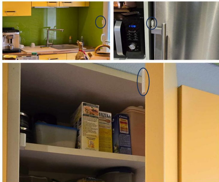
Figure 32. Exemple d'instrumentation de la cuisine : capteur PIR fixé au mur, capteur de contact sur le réfrigérateur (haut) et sur le placard alimentaire (bas).
