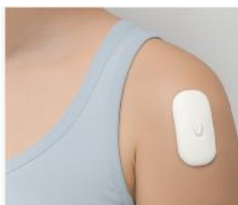
Figure 5. Capteur physiologique porté de type patch pour la mesure continue des paramètres vitaux (fréquence cardiaque, SpO_2 , température, activité électrodermale) [134].
