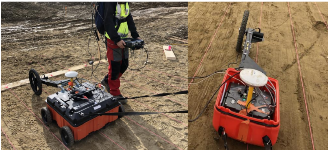
FIGURE 1.16 – Dispositif d’acquisition des radargrammes au sol : antenne 200 MHz (gauche) et 350 MHz (droite) avec roue codeuse et GPS (Global Positioning System), connectés au SIR 4000
