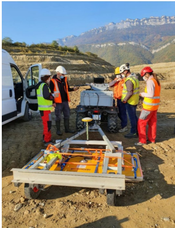
FIGURE 1.1 – Exemple illustratif d'un système GPR déployé sur le terrain il s'agit du dispositif d'acquisition avec le 3D-radar de Géolithe. Cette image ne correspond pas au dispositif utilisé pour les campagnes décrites dans cette thèse, mais sert uniquement à visualiser un exemple de configuration typique.
