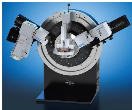
Figure 2.17 : Schéma représentatif de la loi de Bragg dans un cristal et exemple d'un équipement Bruker en configuration Bragg-Brentano.
