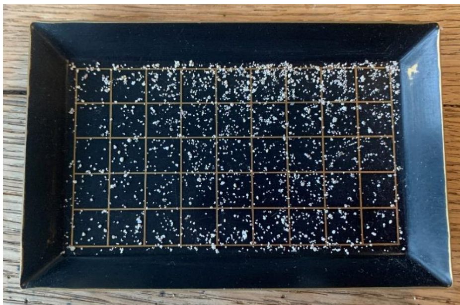
Figure 2.10: Ce récipient permet l'analyse, à l'aide d'une loupe binoculaire, des grains constituant les échantillons et le comptage des cendres. Les carrés facilitent le repérage lors de la mesure.
