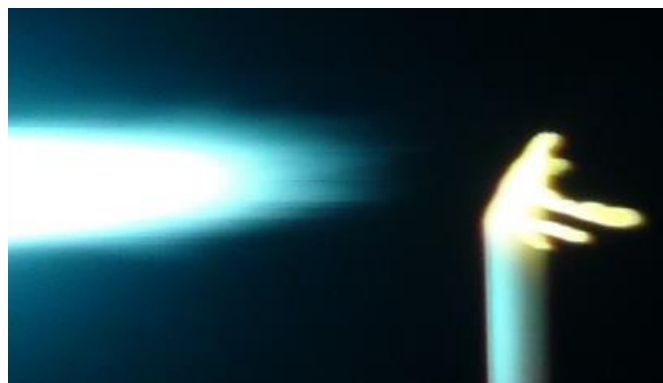
Fig. 4.1 Photographie de l'extrémité d'une baguette d'alumine en fusion à l'approche du jet plasma
