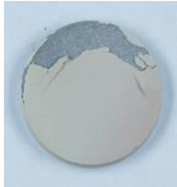
Fig. 6.4 Exemple d'un pion écaillé à 20% après cyclage
