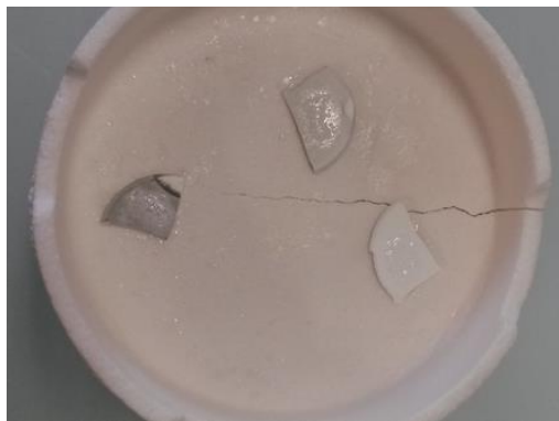
Fig. 3.4 Exemple visuel de morceaux de revêtements vus du dessus après infiltration à 1250°C – 1h
