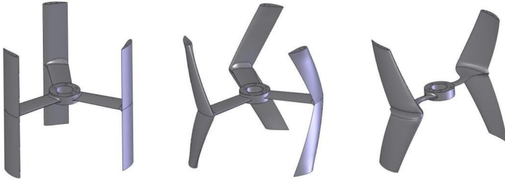
FIGURE 1.5 – Illustration de différents concepts de turbines à flux transverse et axe vertical brevetés par Achard. Source [11]
