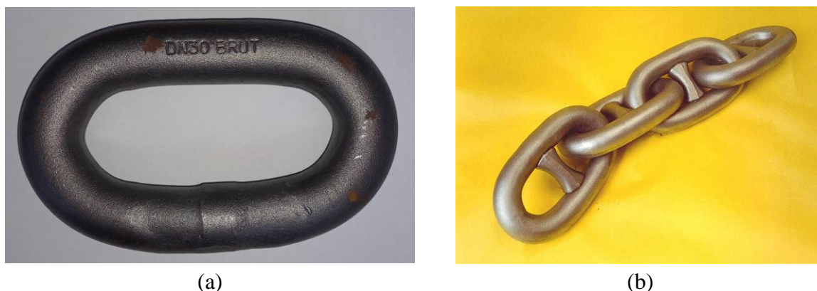
Figure I-23 – Mailles de chaînes. (a) Échantillon de maille neuve, sans étai, fourni par l'entreprise Carlier (Carlier, 2024). La soudure est visible dans sa partie inférieure, le bourrelet associé a été supprimé mécaniquement. (b) Mailles avec étais (Marit, 2024).
