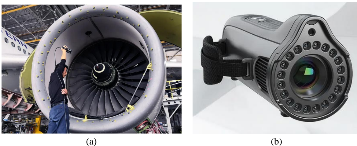
Figure I-56 – Utilisation d'un scanner photogrammétrique SCANTECH MSCAN-L15 dans le cadre de la numérisation d'un réacteur d'avion. On peut noter la présence de motifs collés sur le réacteur qui permettent la simplification et l'amélioration du processus d'alignement des images (SCANTECH, 2023).
