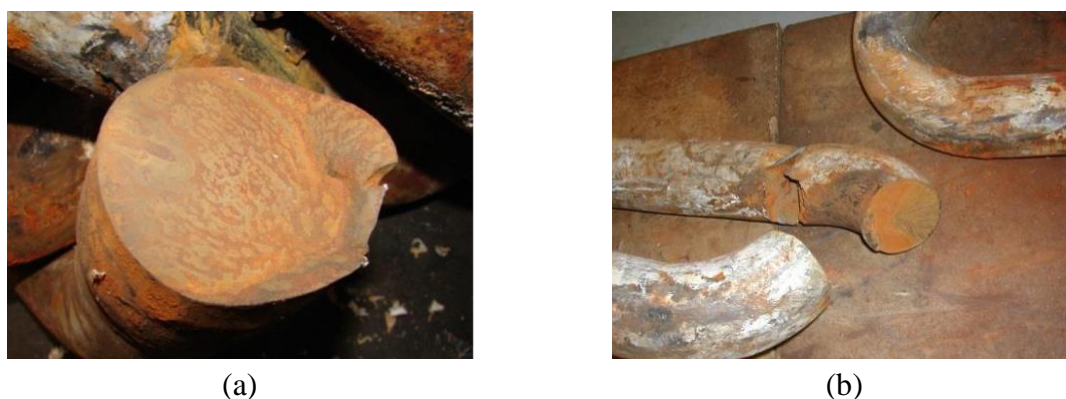
Figure I-30 - Exemples de ruptures par fatigue de chaînes de grade R4 ou R5, sous sollicitations de traction uniaxiale (Fernández et al., 2014).
