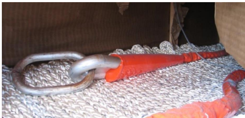
Figure I-18 - Cosse de liaison entre la chaîne d'extrémité et la corde en Nylon® de l'ancrage de la bouée météorologique « Antilles 2 ». Photo prise au Centre de Météorologie Marine de Brest (CMM).
