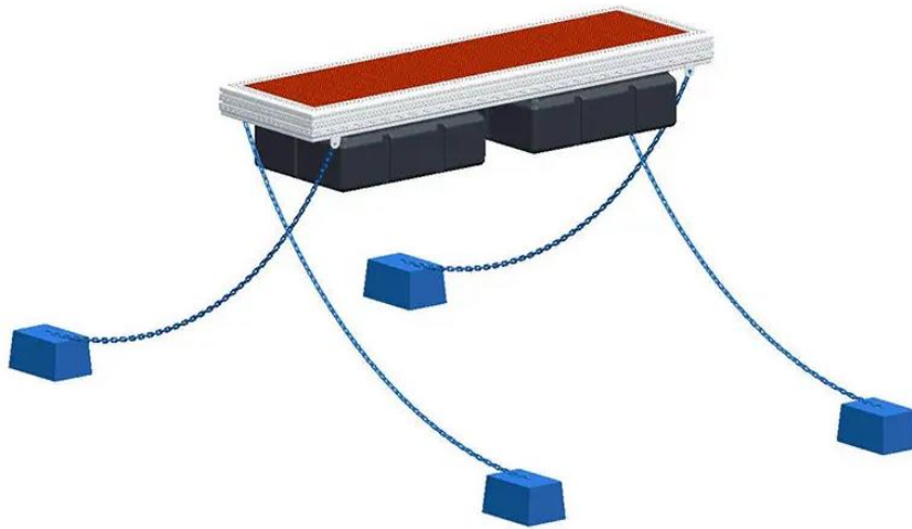
Figure I-20 - Ponton flottant modulaire positionné sur ancrages par chaînes et corps-mort (Hong Kong Horizon Marine Industry, 2024).
