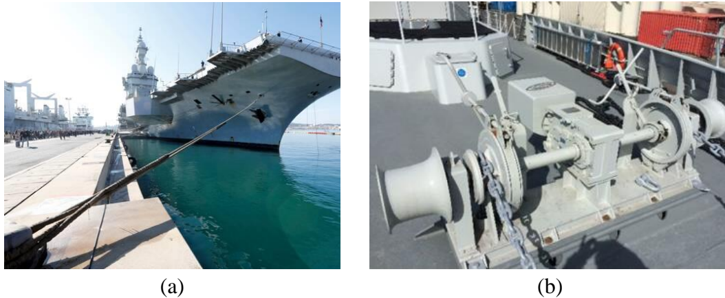
Figure I-7 – Spécificités des amarrages : (a) haussières du porte-avions « Charles de Gaulle » dans le port de Toulon (Var-matin, 2023), (b) guindeaux et barbotins (Boop, 2024).
