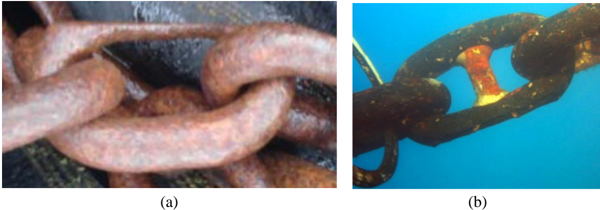
Figure I-51 – Usures externes : (a) usure externe très importante sur un bras d'une maille de chaîne relevée (Steenkiste et al., 2011), (b) usure externe sur un bras d'une maille de chaîne toujours en fonctionnement (Sachan, 2019).
