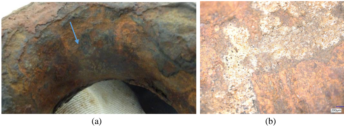
Figure I-48 –Maille de chaîne immédiatement sortie de l’eau de mer. (a) Les zones gris clair qui laissent entrevoir le métal à nu sont uniquement présentes dans les cintres, au niveau du contact intermaille. (b) Surface de contact agrandie avec microscope Keyence. L’acier nu apparaît nettement au contact entre des zones corrodées.
