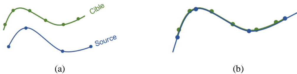
Figure III-1 – Coïncidence de maillages : (a) nuage de points source et nuage de points cible construits à partir d'une même surface physique, (b) superposition exacte des deux surfaces, mais non coïncidence des nœuds des maillages.
