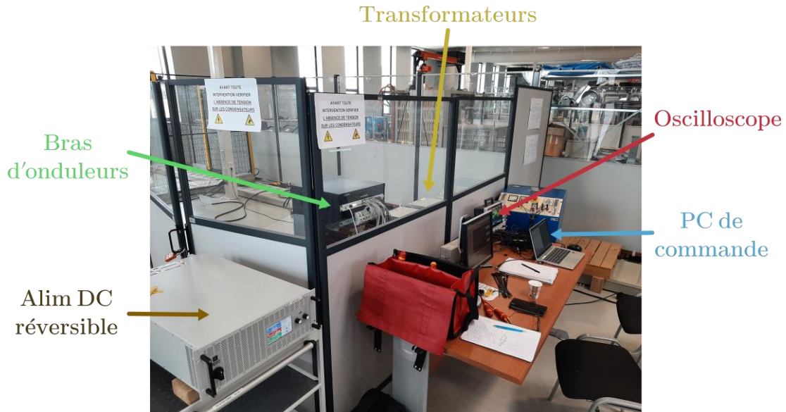
Figure IV-16. Banc de test des deux onduleurs sur la plateforme d'essai ZEUS à la SCLE.
