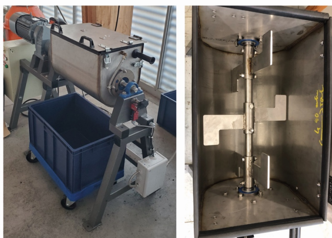
Figure 34 : Mélangeur à pales conçu sur mesure pour la société Api'Up
