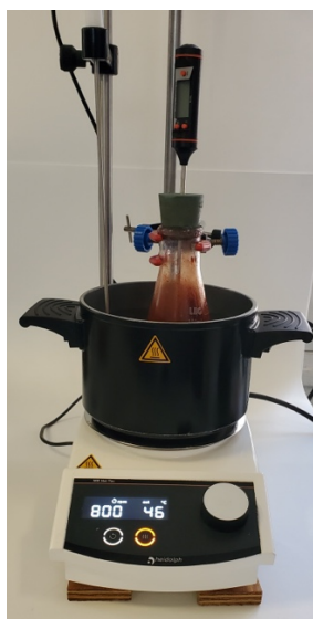
Figure 147 : Montage utilisé pour les décoctions
