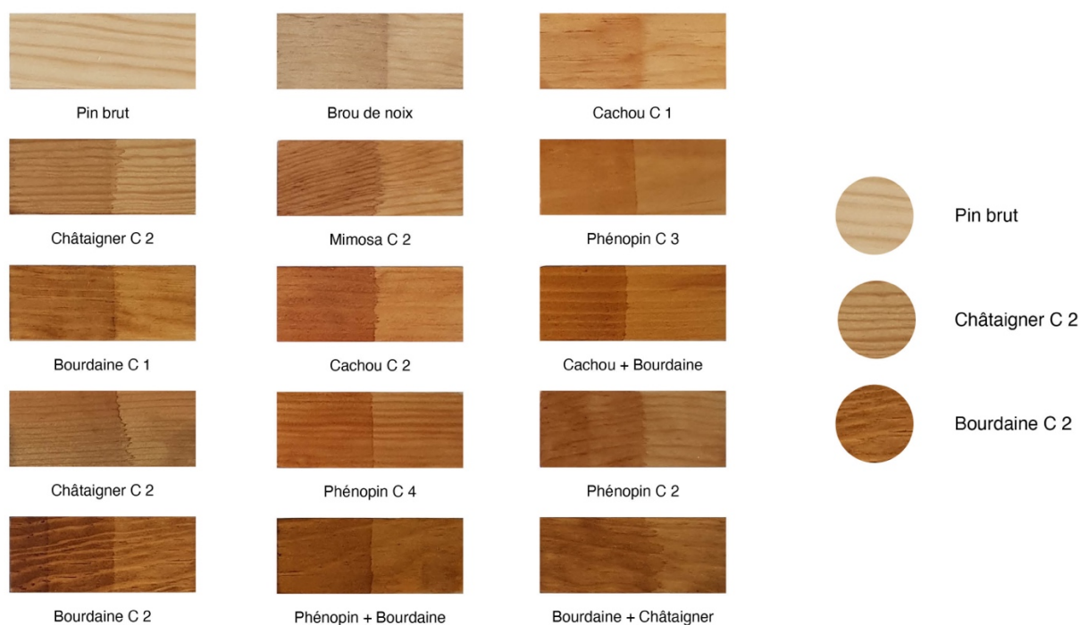
Figure 160 : Nuancier des premiers essais de teinture et les teintes retenues par Api'Up
