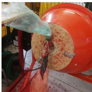
Figure 50 : Bétonnière modifiée en cours d'utilisation
