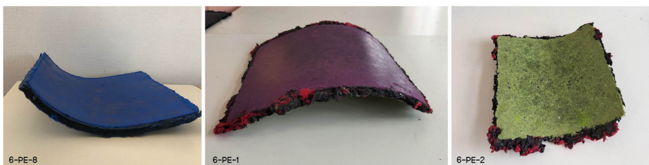
Figure 101 : Résultat des essais de cintrage dans le moule à petit rayon de courbure
