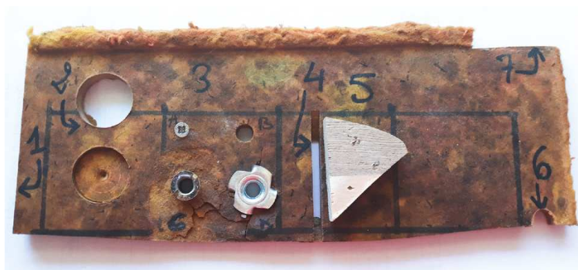
Figure 102 : Essais d'usinages sur un panneau en polyester
