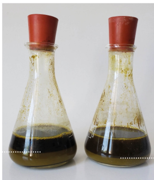
Figure 151 : Dépôt insoluble après décoction du Solidage en deux concentrations différentes
