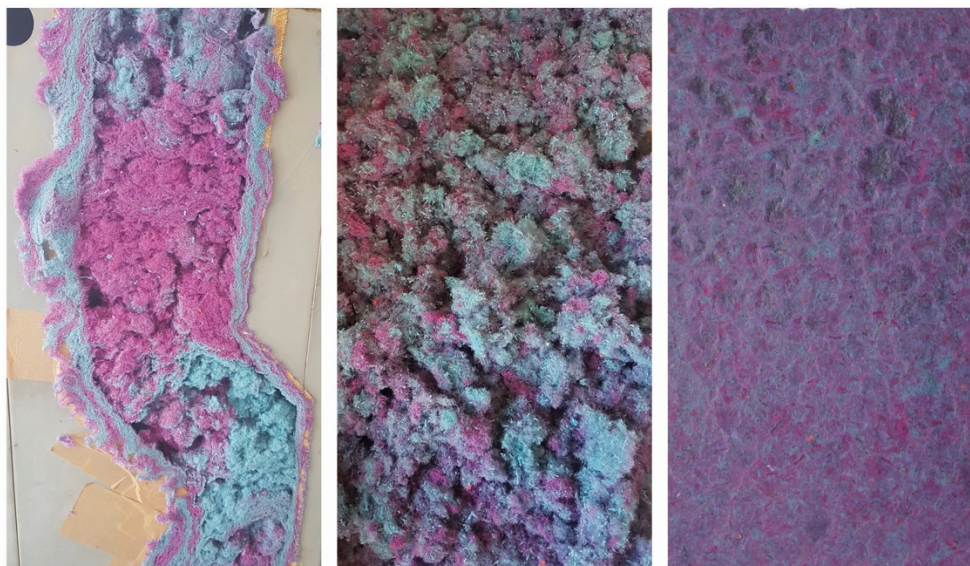
Figure 92 : Homogénéisation de la couleur par le cardage des fibres
