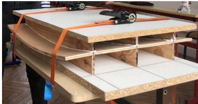
Figure 86 : Moule de ceintrage du polyester avec un grand rayon de courbure
