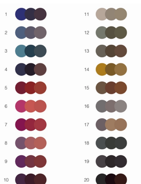
Figure 105 : Relevé chromatique des échantillons textiles allant réagit à la chaleur
