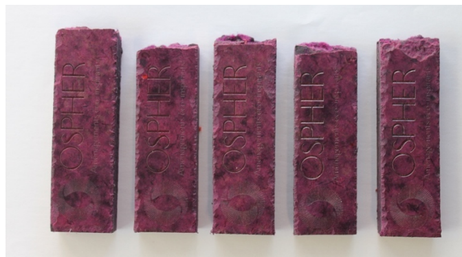
Figure 103 : Essais de gravure laser sur panneaux textiles
