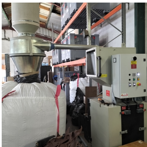
Figure 33 : Broyeur à couteaux d'Api'Up
