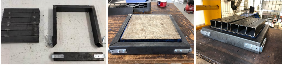
Figure 85 : Moule fabriqué au laboratoire pour le pressage des panneaux textiles
