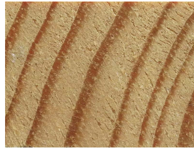
Figure 139 : Cernes du pin maritime en coupe transversale sur le plan RT
