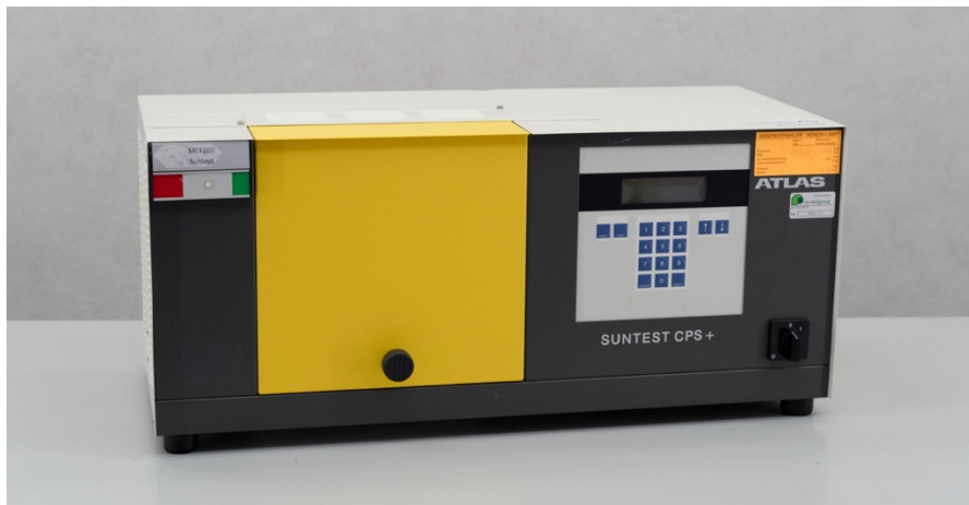
Figure 153 : Suntest Atlas utilisé pour le vieillissement accéléré à la lumière
