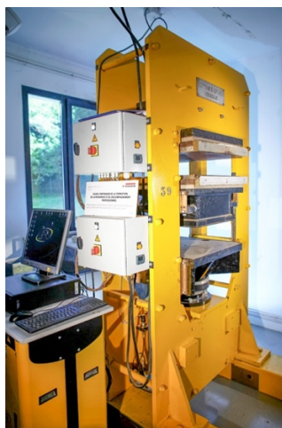
Figure 35 : Presse à thermocompression Pagnioni Monza / 3R
