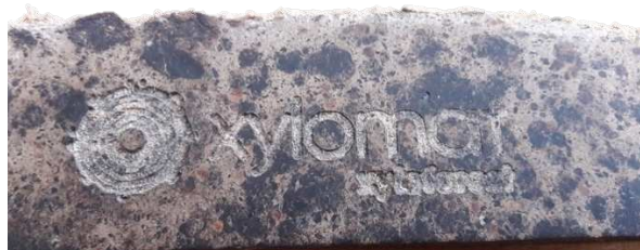
Figure 66 : Test d'usinage sur la première plaquette en cuir "rigide" obtenue
