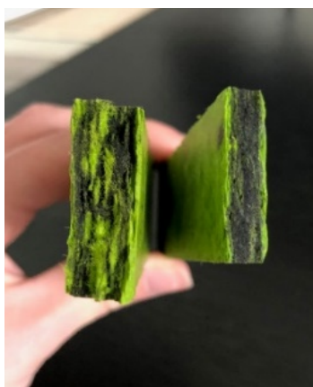
Figure 96 : Observation de la cohésion de la couche interne non cardé (gauche) et cardé (droite)
