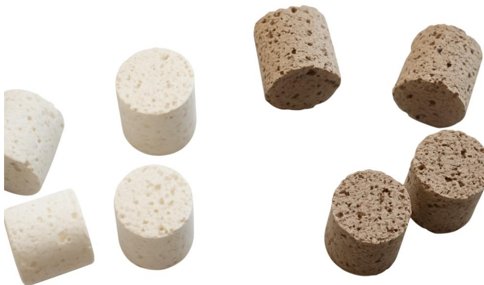
Figure 5-3 Photo des cylindres de céramiques phosphocalciques mises en forme par PIM, à gauche une céramique non dopée et à droite une céramique dopée à 2% en cuivre, zinc et strontium.
