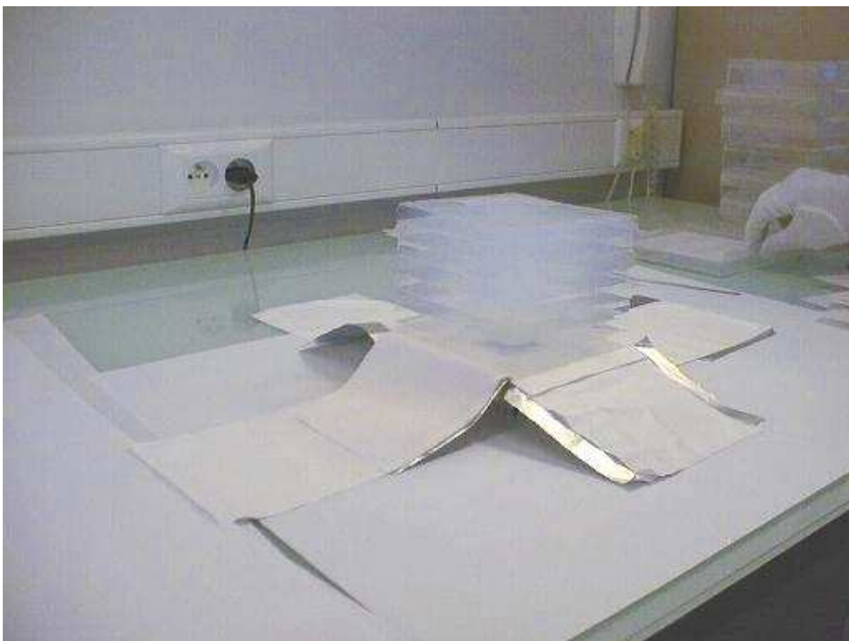
FIG. 5.4: Photographie d'une cellule d'aérogel lors de son enrobage à l'ISN. On peut distinguer les huit blocs d'aérogel, ainsi que les trois couches de téflon et la feuille d'aluminium, utilisée en complément pour la réflexion de la lumière Čerenkov sur les parois.
