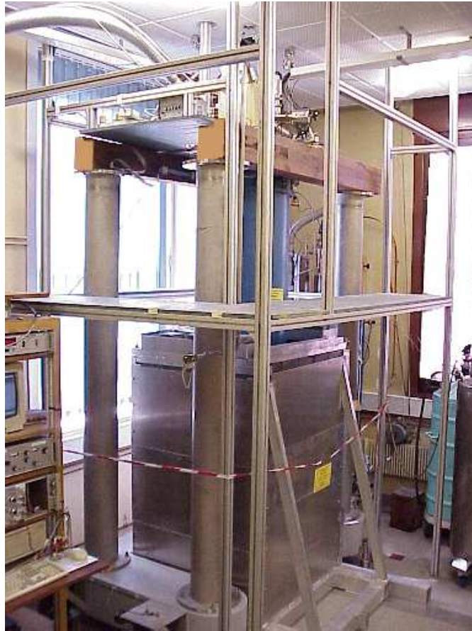
FIG. 8.2: Photographie du cryostat (au centre en bleu) muni du blindage de Plomb, lors de l'expérience au CRTBT. La cellule d' ^3\text{He} se trouve à mi-hauteur du blindage.
