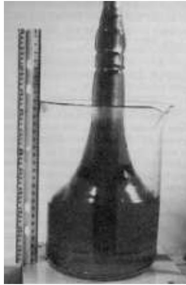
FIG. 2.4: Récipient fixe avec bâton tournant. La solution de polyacrylamide monte le long du bâton [9].
