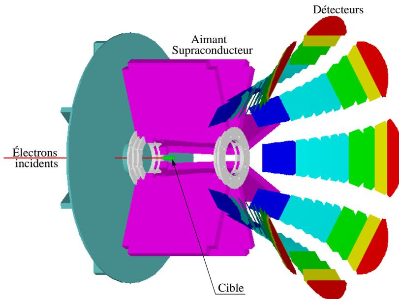
FIG. 3.3 – Vue schématique du spectromètre  $G^0$ .
