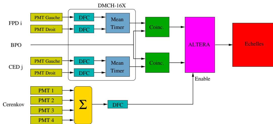
FIG. 3.28 – Schéma représentant l'architecture d'une voie d'électronique aux angles arrière permettant la coïncidence du FPD  $i$  avec le CED  $j$ . Il y a un seul module ALTERA par carte d'électronique permettant la création de la matrice de coïncidence de 2 secteurs de détection [122].
