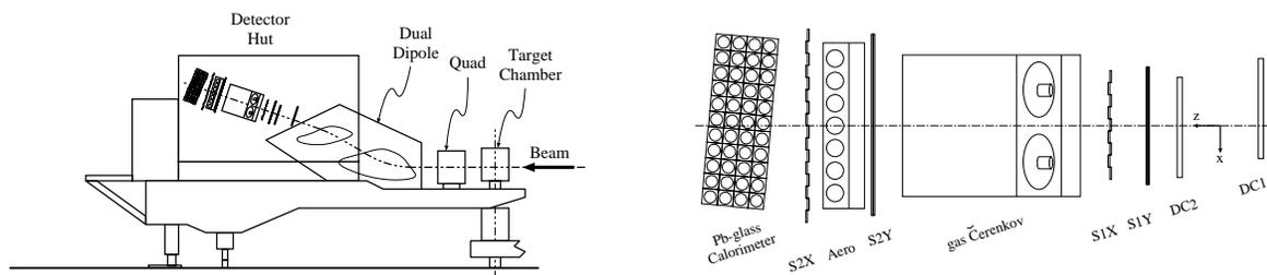
FIG. 3.11 – **A gauche** : Vue schématique du spectromètre SOS. **A droite** : partie détection du spectromètre SOS constituée de deux chambres à dérive (DC1 et DC2), de quatre plans d'hodoscope (S1X, S1Y, S2X et S2Y), de deux Čerenkov, un à gaz l'autre à aérogel et d'un calorimètre de verre au plomb.
