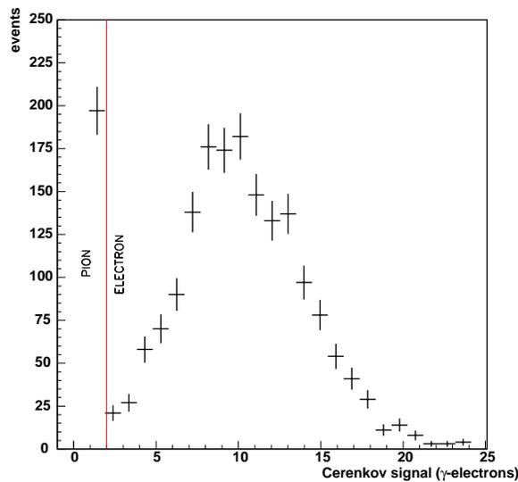
FIG. 3.20 – Spectre d'identification typique provenant du Čerenkov à gaz du SOS.
