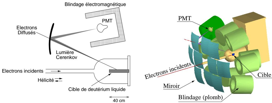
FIG. 4.8 – **A gauche** : Schéma en deux dimensions du système de détection de l'expérience SAMPLE (seul un détecteur est montré sur cette figure par esprit de simplification). **A droite** : Schéma en trois dimensions.
