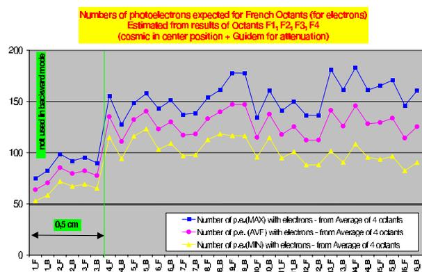
FIG. B.4 – *Estimation du nombre de photo-électrons détectés par les photo-multiplieurs dans la phase angles arrière en fonction du détecteur.*
