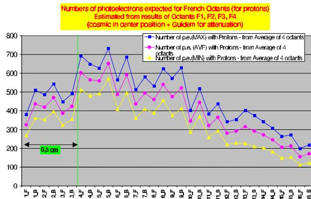
FIG. B.3 – *Estimation du nombre de photo-électrons détectés par les photo-multiplieurs dans la phase angles avant en fonction du détecteur. Note : les suffixes "F" et "B" réfèrent respectivement au détecteur "Front" et "Back" constituant une paire de FPD.*
