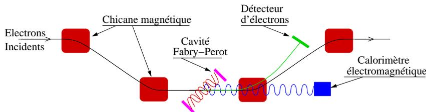
FIG. 2.13 – Schéma représentant le polarimètre Compton du TJNAF.
