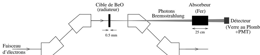
FIG. 2.10 – Schéma du polarimètre à transmission du MIT-Bates.
