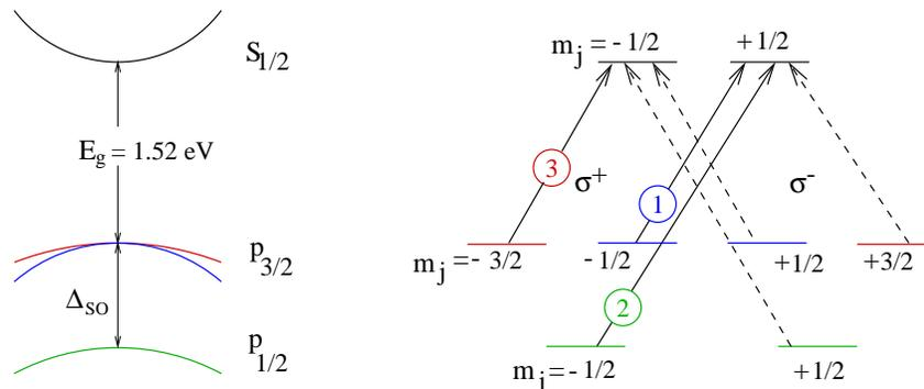
FIG. 2.3 – Structure en bande d'un cristal de GaAs.
