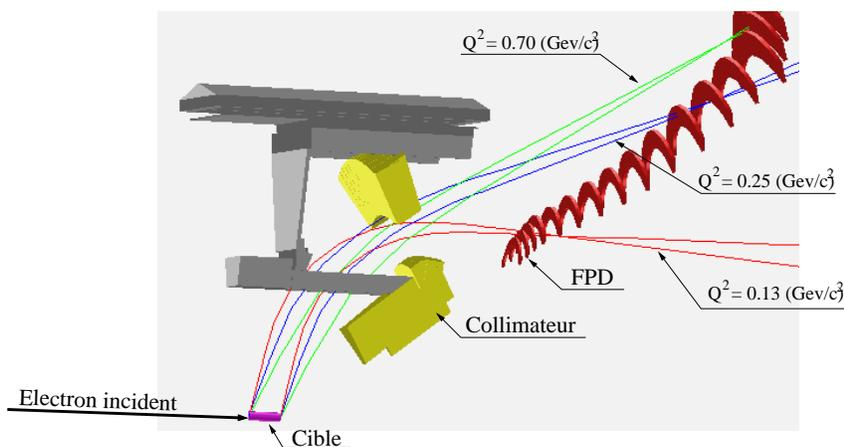
FIG. 3.8 – Trajectoires suivies par des protons provenant de diffusions élastiques à  $Q^2 = 0.13$ ,  $Q^2 = 0.25$  et  $Q^2 = 0.7$   $(\text{GeV}/c)^2$ . Il est à noter que quelque soit le point de départ dans la cible, les protons de même quadri-impulsion sont détectés par le même détecteur.
