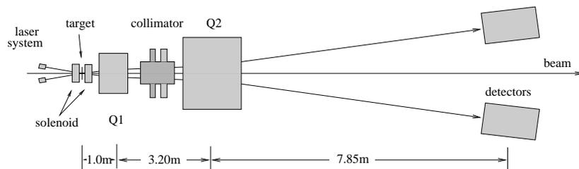
FIG. 2.12 – Schéma du polarimètre Møller du hall C.
