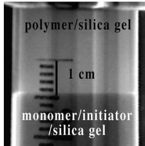
FIG. 3.3 – Un front de polymérisation avec un monomère et un polymère séparés par un gradient de concentration très élevé. Du gel de silice est utilisé pour empêcher la convection. Adapté de [14].
