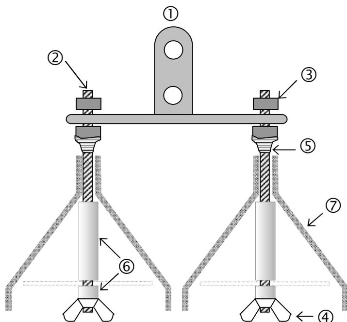
Légende : ① 1 té en acier, 8 cm de large, 4 cm de hauteur, percé  $\varnothing$  6 mm 2 fois sur la hauteur (2,1 cm d'écart) et aux deux extrémités horizontales ; ② 2 tiges filetées en Inox, longueur 8,5 cm ; ③ 4 écrous  $\varnothing$  6 mm ; ④ 2 écrous-papillons  $\varnothing$  6 mm ; ⑤ Teflon ; ⑥ tuyaux plastiques,  $\varnothing$  adapté à la tige filetée, 2 morceaux d'une longueur de 35 mm et 2 morceaux de 5 mm ; ⑦ 2 entonnoirs en plastique, hauteur 6,8 cm,  $\varnothing$  6,5 cm.
