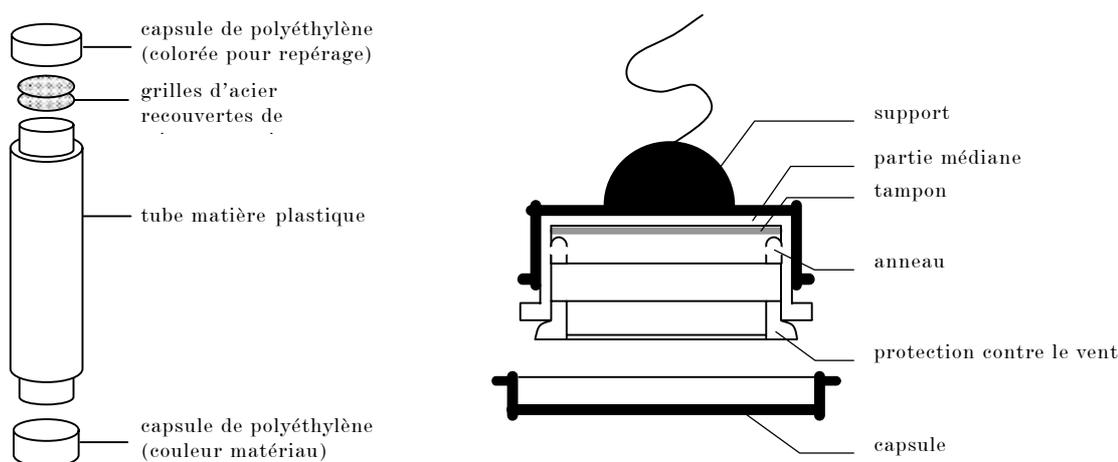
Figure 18 : Deux types de capteurs passifs – Le tube à diffusion passive pour dioxyde d'azote ( $\text{NO}_2$ ) [ATKINS, 1990, p. 45] et le badge pour dioxyde de soufre ( $\text{SO}_2$ ) et dioxyde d'azote ( $\text{NO}_2$ ) [KROCHMAL *et* KALINA, 1997, p. 3474]
