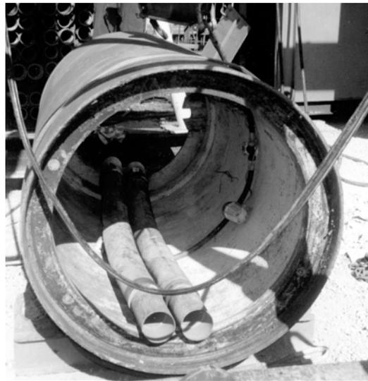
Figure I.13 : photo du tuyau suiveur
