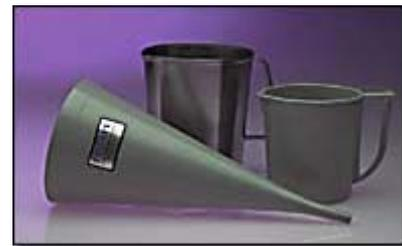
Figure.V.16 : Viscosimètre Marsh
