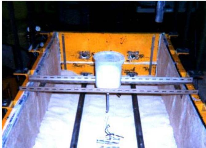
*Figure 4 : Vue du mini pluviateur*
