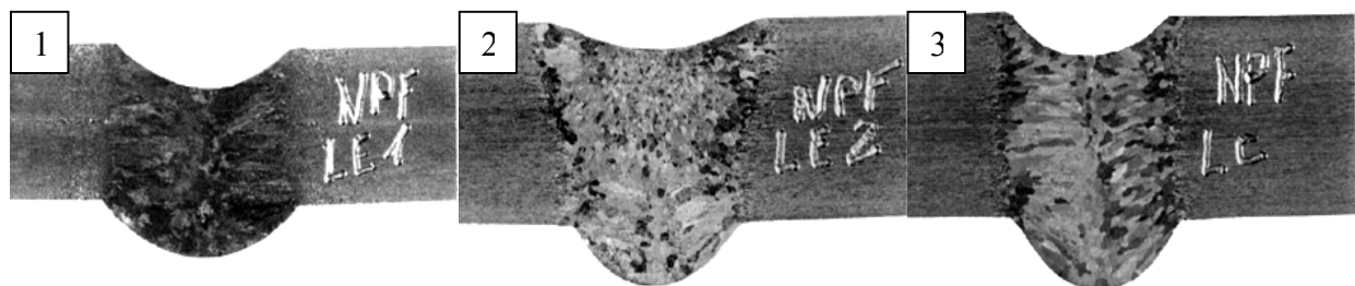
Figure IV.41 : Soudures manuelles et automatiques d'aciers inoxydables austénitiques (1 et 2 - 180A manuel) et d'acier inoxydable duplex austéno-ferritique (3 - 180A - 15cm/min)
