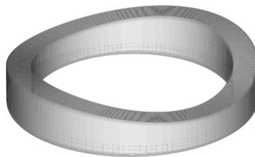
FIG. 1.7 – Ondulations sur la face du rotor
