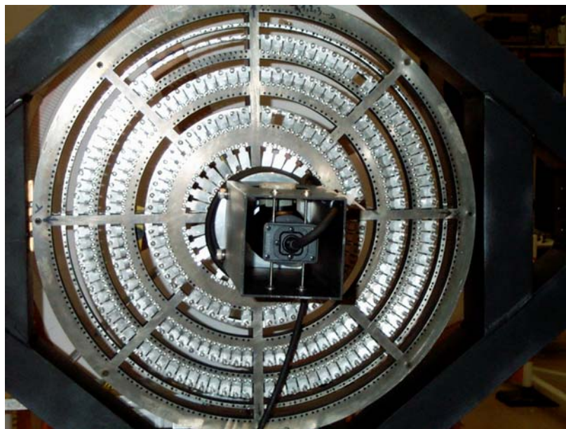
Fig IV-I-2 : Image de la lentille gamma en cours de remplissage en cristaux. Certains anneaux sont partiellement remplis, d'autres totalement vides (couronnes noires) ou complets. Les cubes gris correspondent aux cristaux de germanium.
