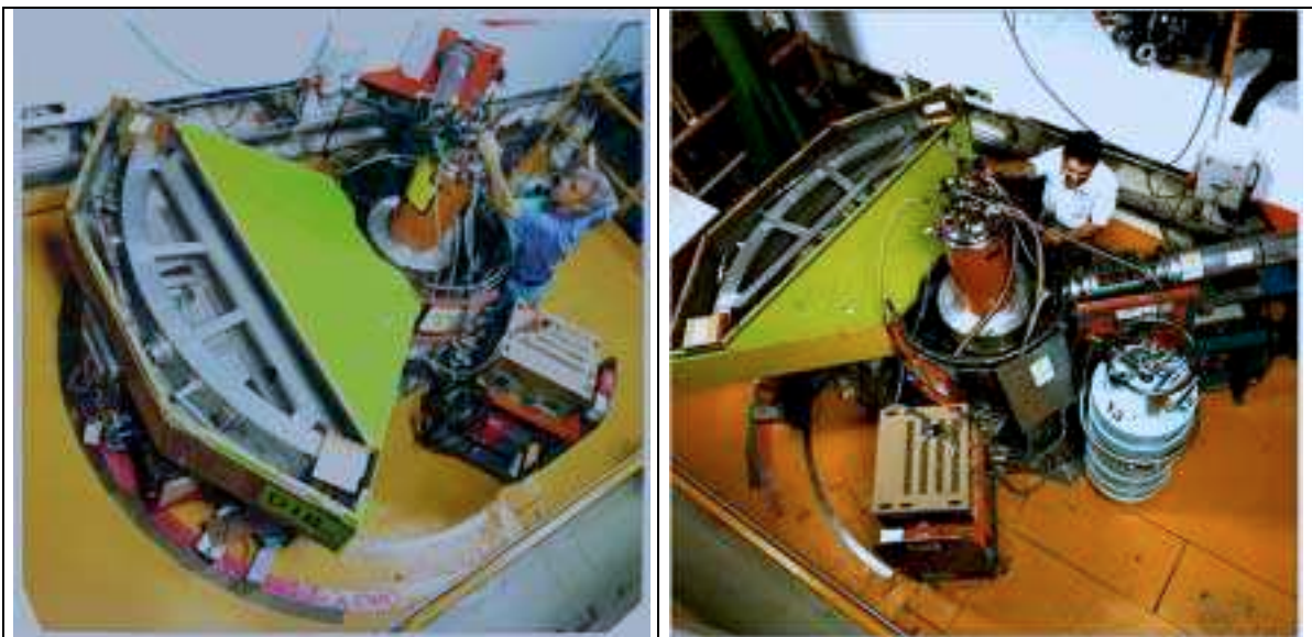
Figure II.11 : Photographies du diffractomètre D1B de l'I.L.L. équipé du cryostat ILHV25
