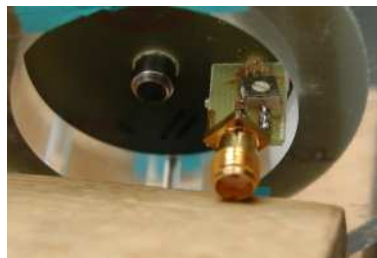
FIG. 7.19 – Photographie de l'extérieur du système court-circuit, support SMA, pion de centrage et connecteur SMA
