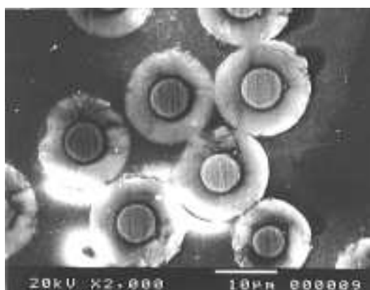
FIG. 11.2 – Vue en coupe de fils ferromagnétiques gainés de verre
