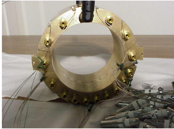
FIG. 3.4 – Coussinet d'essai
