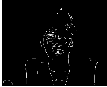
FIG. 1.7 – Illustration de l'approche par extraction du passage par zéro du Laplacien puis par seuillage
