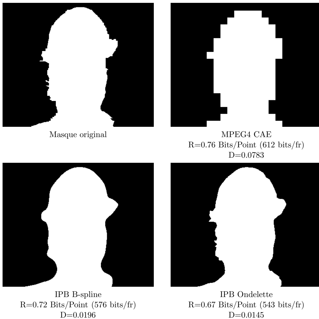
FIG. 3.2 – Comparaison des techniques de codage pour un débit d'environ 0.7 bits par élément de contour (environ 600 bits par images à 15Hz)
